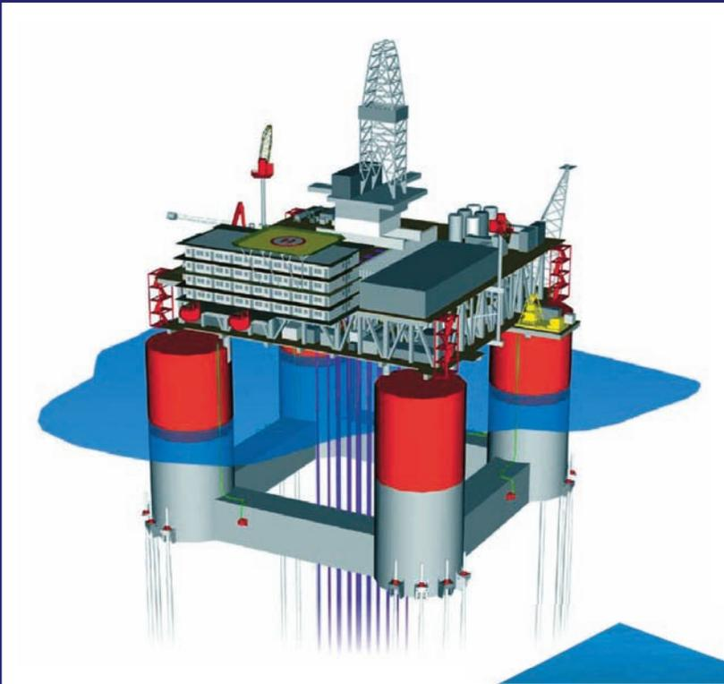
*Modelo de plataforma do tipo TLP (Tension Leg Platform) com sistema de completação seca, que está sendo cogitada para o pré-sal*
